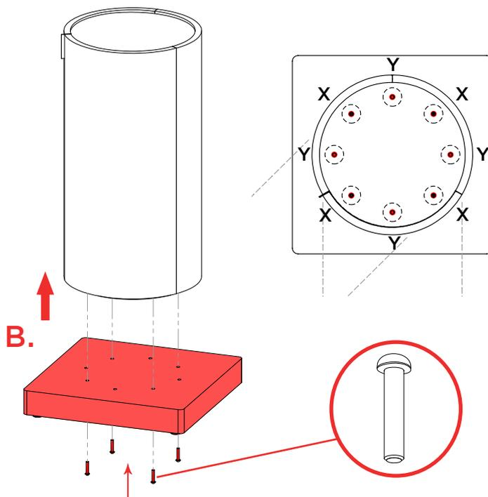
2. Unire il basamento al modulo con le viti TBCE M8x35 in dotazione.
